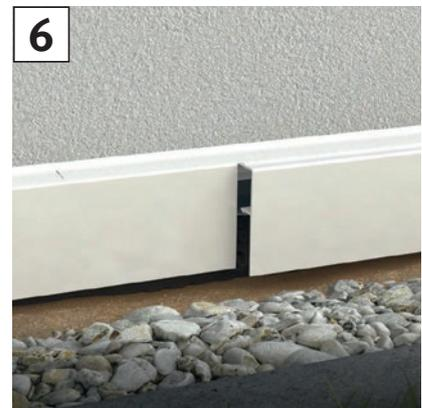
**6** Danach PVC-Abdeckprofil 37527 im gewünschten Farbton einklippen. Kabel oder Mikroschlauch kann eingelegt werden. Stoßüberlappung der PVC-Abdeckprofile mit dem Aluminium-Grundprofil sicherstellen. Am Stoß der Einzelstäbe einem Abstand von 1 - 2 mm belassen.
